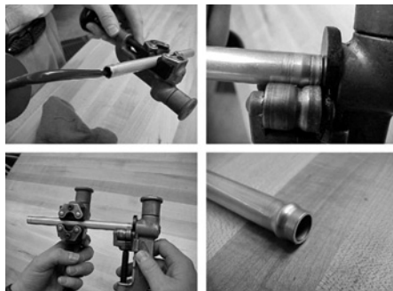
26 pav. Rankinis valcavimo įrankis ir valcavimo procesas
