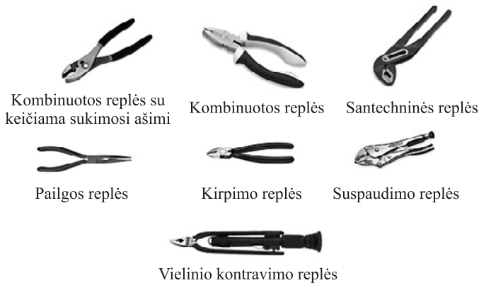
8 pav. Orlaivių techninei priežiūrai naudojamos replės
