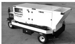
65 pav. Didelis mobilus išorinis elektros energijos šaltinis su generatoriumi
