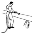
73 pav. Mažo orlaivio užpildymas degalais per sparno viršuje esančias angas
