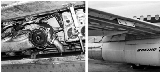
74 pav. Didelio orlaivio užpildymo degalais per vieno tašką sistemą
