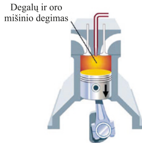
1.10 pav. Dyzelio darbas darbo eigos takto metu.
