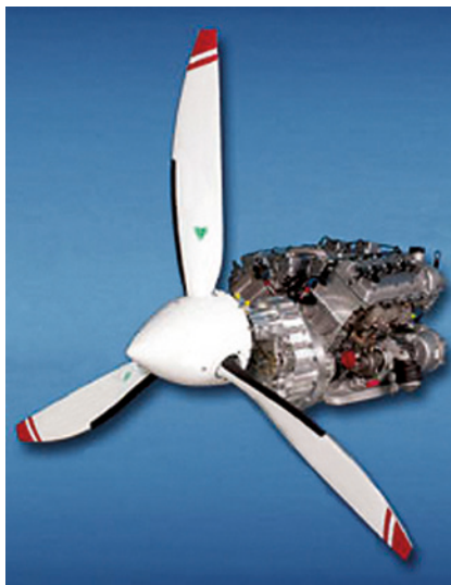
1.7 pav. Naujausios kartos aviacinis dyzelinis variklis „Theilert Centurion 4.0“.
