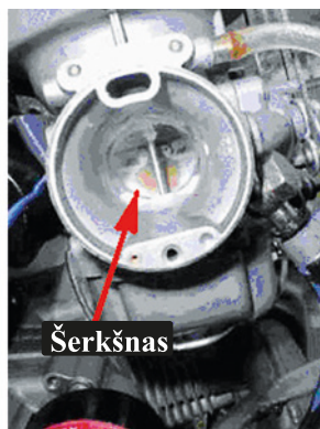
Apšerkšnijęs variklio ROTAX 912 karbiuratoriaus difuzorius.
