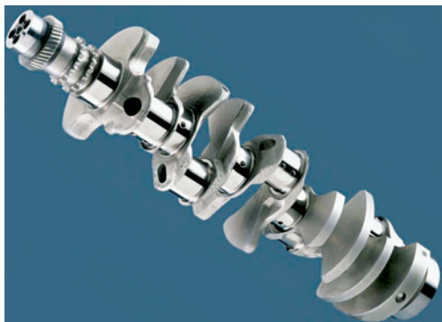
7.12 pav. Vienaeilio variklio alkūninis velenas. Kairėje viršuje matyti agregatų pavaros krumpliaratis. Veleno kakliukuose išgręžtos tepimo kiaurymės.
