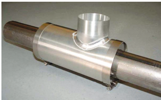
8.10 pav. Karbiuratoriaus apšildymo sistemos šilumokaitis.
